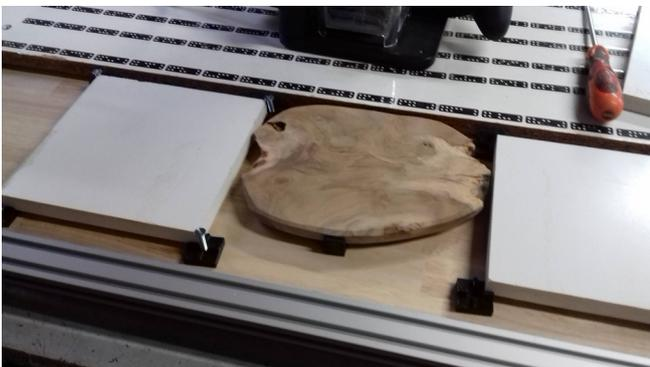
Celle-ci doit être au même niveau que celui du plan de travail. Donc il va falloir régler le plateau supportant votre pièce en hauteur (4 vis tête fendue),
