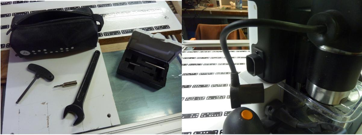
Débrancher le connecteur d'alimentation du corps de Shaper
