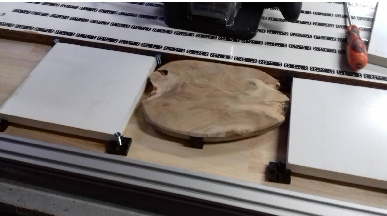
**Celle-ci doit être au même niveau que celui du plan de travail.** Donc il va falloir régler le plateau supportant votre pièce en hauteur (4 vis tête fendue au quatres coins dudit plateau) et **la fixer fermement, du double face convient parfaitement, et avec la règle horizontale.**
